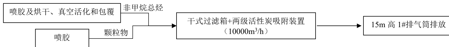
图 4-1 本项目废气处理流程图
